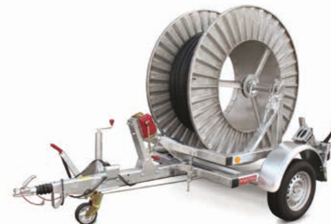
Trommelhenger KVS (G), trommelhenger med rett drag, utstyrt med kulekobling
