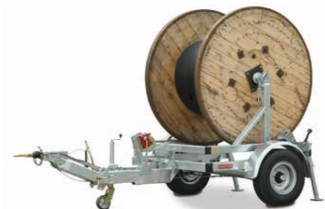
Trommelhenger KVS (H), trommelhenger med justerbart drag og kulekobling
